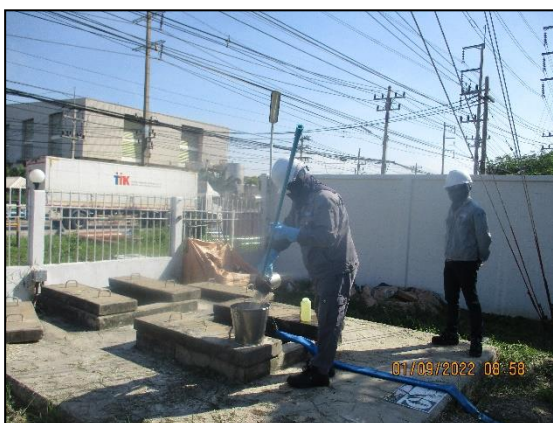
รูปที่ 3-9 การเก็บตัวอย่างคุณภาพน้ำทิ้ง บริเวณ จุดน้ำทิ้งจากบ่อพัก (Inspection Chamber)
