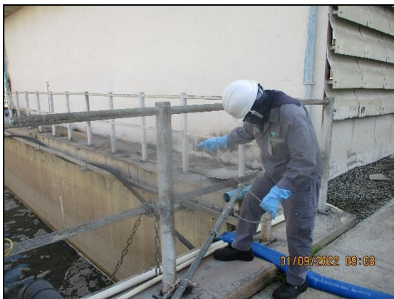
รูปที่ 3-8 การเก็บตัวอย่างคุณภาพน้ำทิ้ง บริเวณ น้ำทิ้งหลังผ่านระบบบำบัด (Retention Pond)
