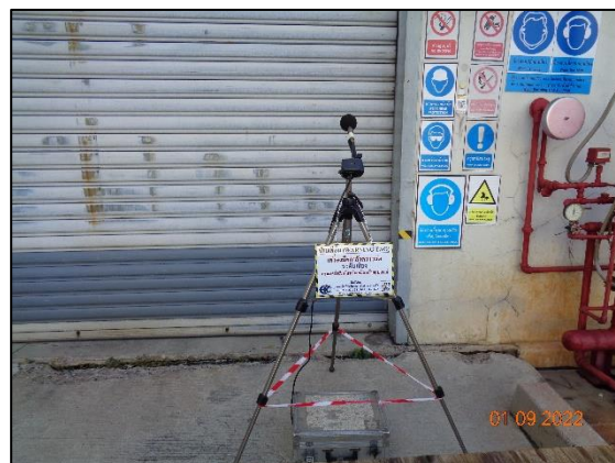
รูปที่ 3-12 การตรวจวัดระดับเสียงในพื้นที่ทำงาน บริเวณ Steam Turbine Generator
