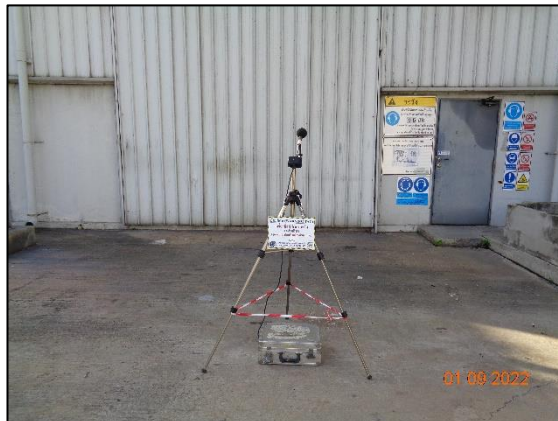
รูปที่ 3-10 การตรวจวัดระดับเสียงในพื้นที่ทำงาน บริเวณ Gas Turbine Generator
