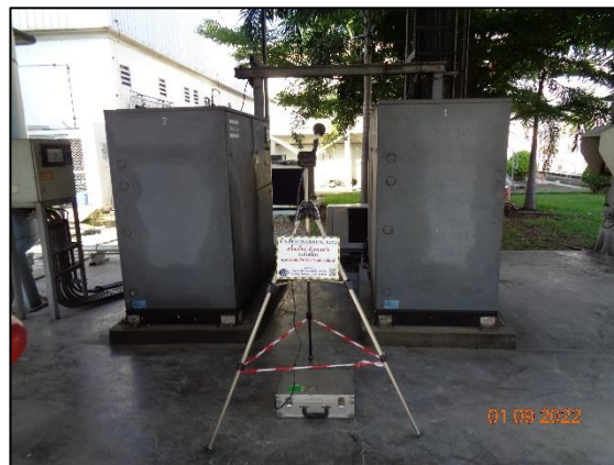
รูปที่ 3-11 การตรวจวัดระดับเสียงในพื้นที่ทำงาน บริเวณ Air Compressor
